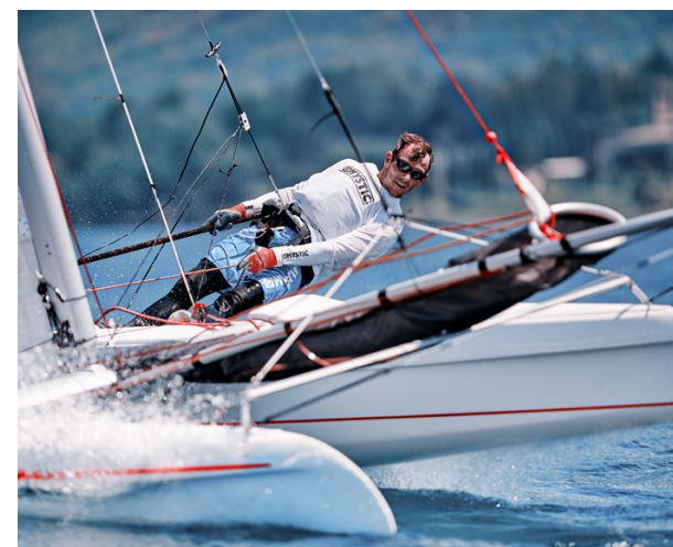
WAVEPIERCER RÜMPFE MIT CHINES FÜR VIEL SICHERHEIT
